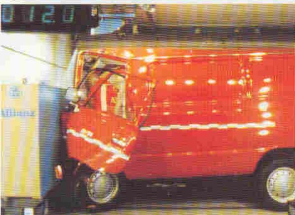
Toyota Lite-Ace: Tür aufgegangen, 65 cm verformt
