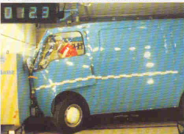
Isuzu Cargo Van: Die Knautschzone betrug genau 40 cm
