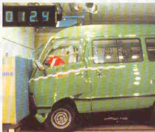
Nissan Vanette: Die Kabine wurde 42 cm kürzer
